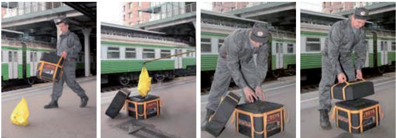
Рисунок 4. Локализаторы взрыва типа «Фонтан», порядок применения.
